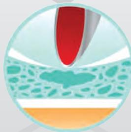
**Abbildung 2:** Unter zunehmenden Druck reißen die dünnen Membranen, die die Tropfen des Gels auseinanderhalten. Eine größere zusammenhängende Menge der antimikrobiellen, gelartigen Flüssigkeit entsteht.
